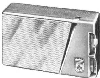
6 Transistoren + 2 Dioden · Mittelwelle · 5 Kreise · Ferrit-Antenne · Gegentakt-Endstufe · Schaltbuchse für Kleinhörer oder Zusatzlautsprecher · 9-Volt-Batterie Kunststoffgehäuse, zweifarbig kombiniert, mit Messing-Clip zum bequemen Aufstellen. Abmessungen 10,4x6,5x2,7 cm. Gewicht ca. 250 g
