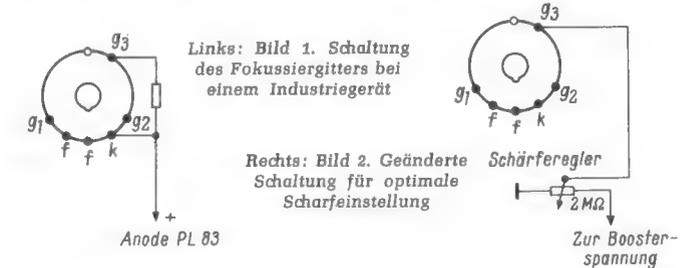
Röhre damit ein verwaschenes und unscharfes Bild erzeugte. Es zeigte sich, daß die Spannung am Gitter  $g_3$  höher eingestellt werden mußte. Um dies bequem zu ermöglichen, wurde  $g_3$  an den Schleifer eines Trimpotentiometers von 2 M $\Omega$  angeschlossen. Das Potentiometer liegt mit seinen Enden zwischen Boosterspannung und Masse, wie Bild 2 zeigt. Die Röhre läßt sich mit dieser regelbaren Fokussierungsspannung leicht auf optimale Schärfe einstellen.
